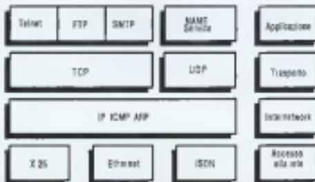
Figure 3 - Principali protocolli del TCP/IP
